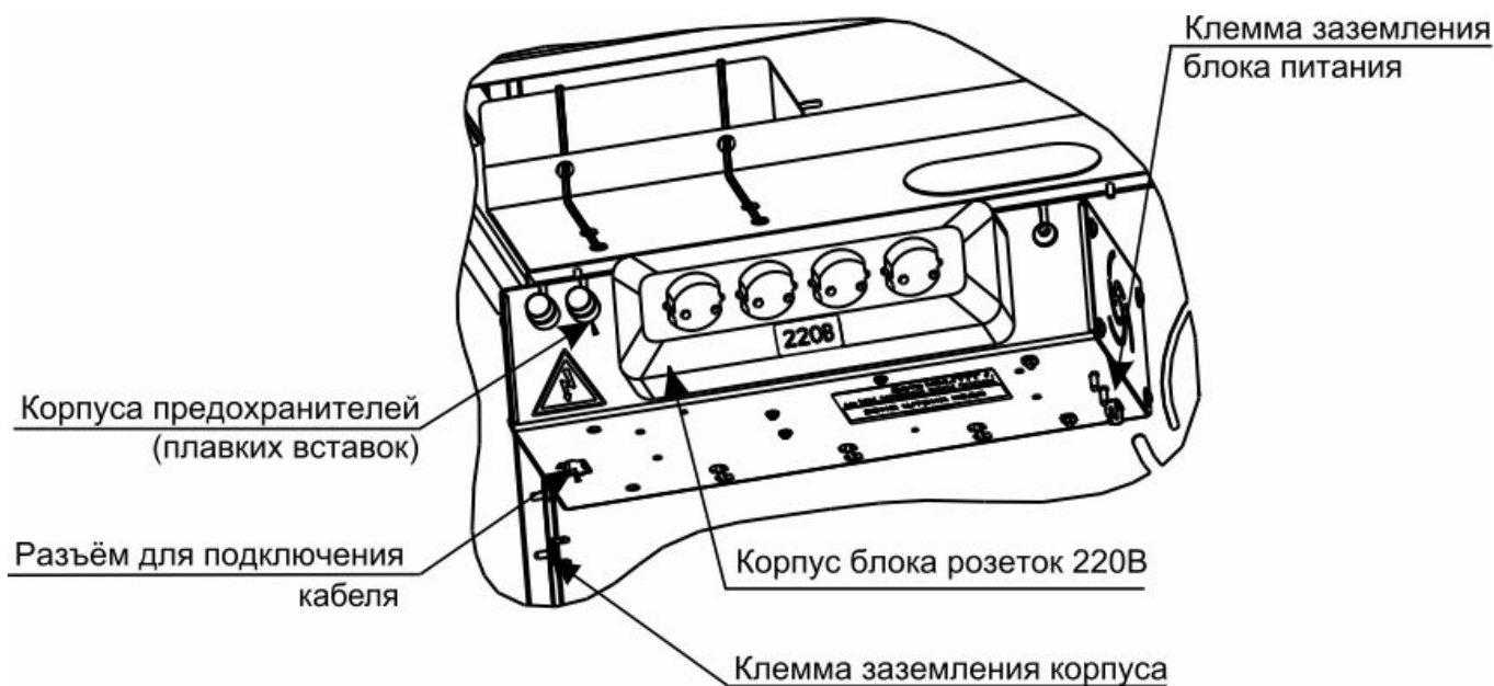
Рисунок 4.28 - Элементы корпуса блока питания
