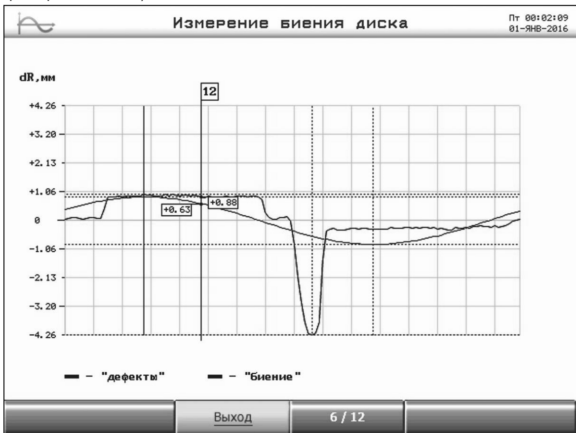
Рисунок 7.6 – Окно измерения биений диска
