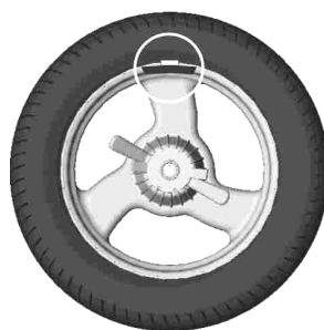
Рисунок 6.6 - Груз установлен в «12 часов»
