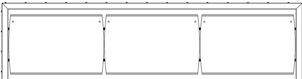
Рисунок 4.4 - установка трех сдвижных пластин в прямик
