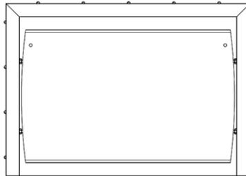
Рисунок 4.2 - установка одной сдвижной пластины в прямик
